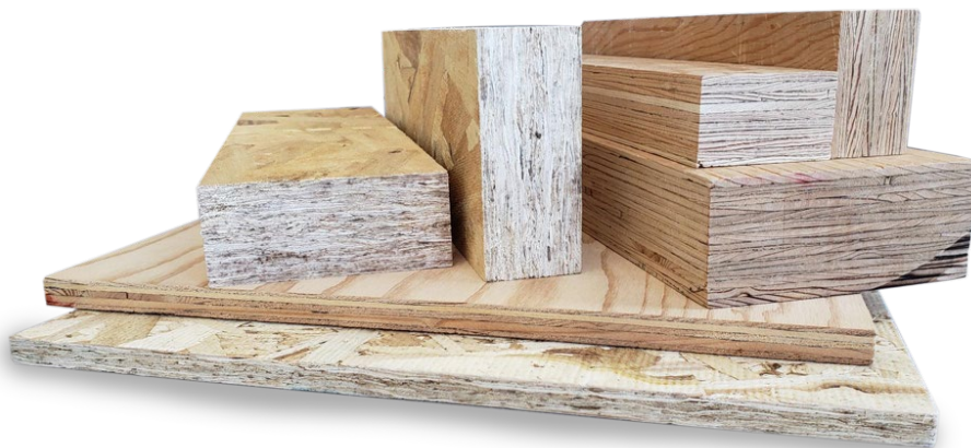
Рис. 3.7 - Клеєний дерев'яні елементи з орієнтованою стружкою (LSL) [47]
