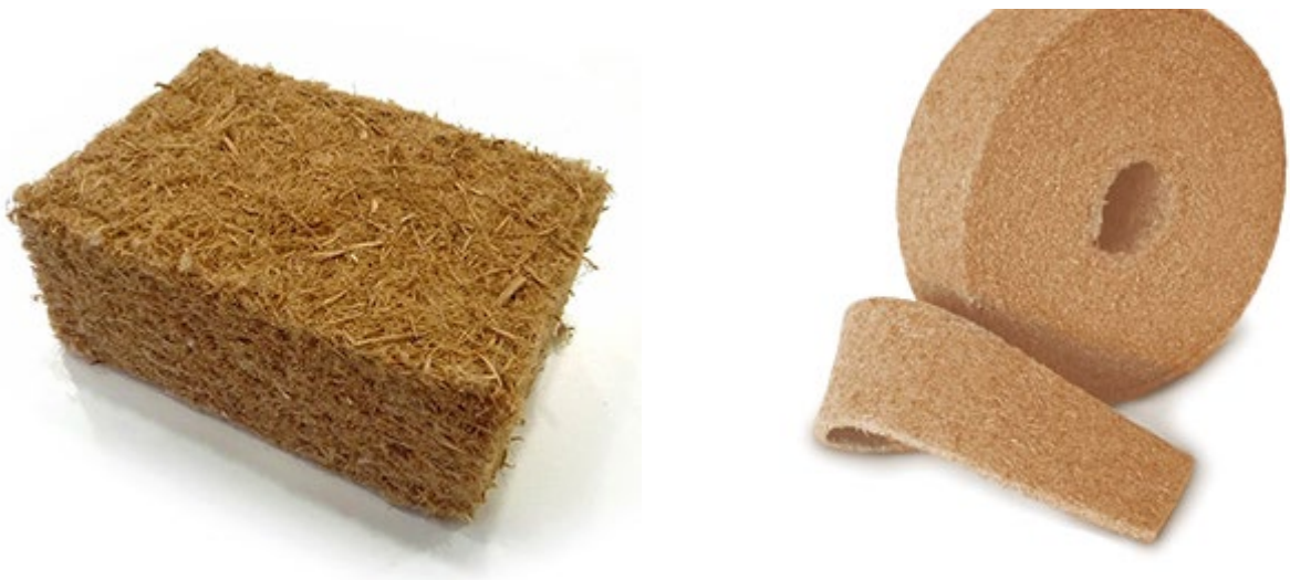
Рис. 3.14 - Теплоізоляція із деревини
