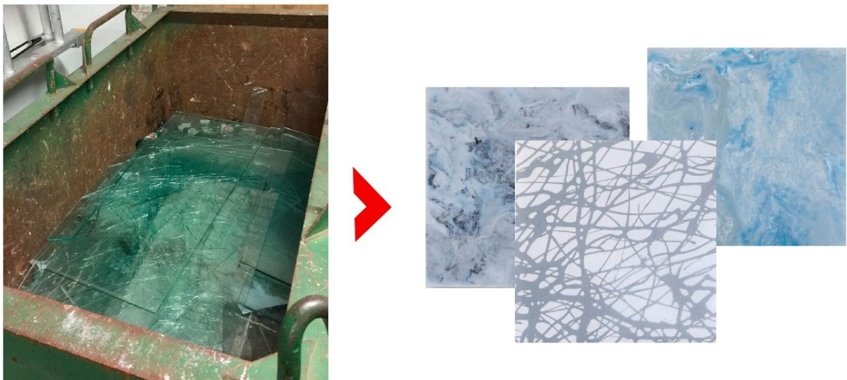
Рис. 3.21 - Рециклінг віконного скла для склополімерних виробів [54]
