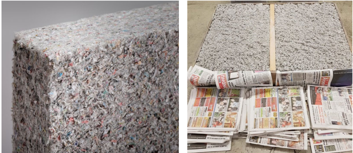
Рис. 3.13 - Теплоізоляція із целюлози
