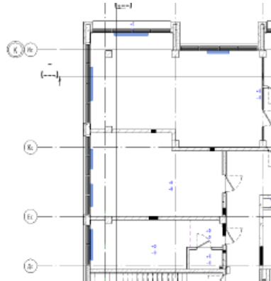
Рис 4.109 - Автоматично розміщені радіатори у приміщеннях
