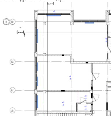
Рис 4.110 - Розміщення внутрішньопідлогових конвекторів
