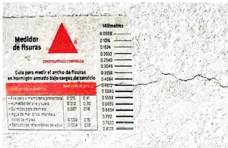
Рис. 3.7. Зовнішній вигляд картки для визначення ширини розкриття тріщин / Appearance of the card for determining the width of crack opening
