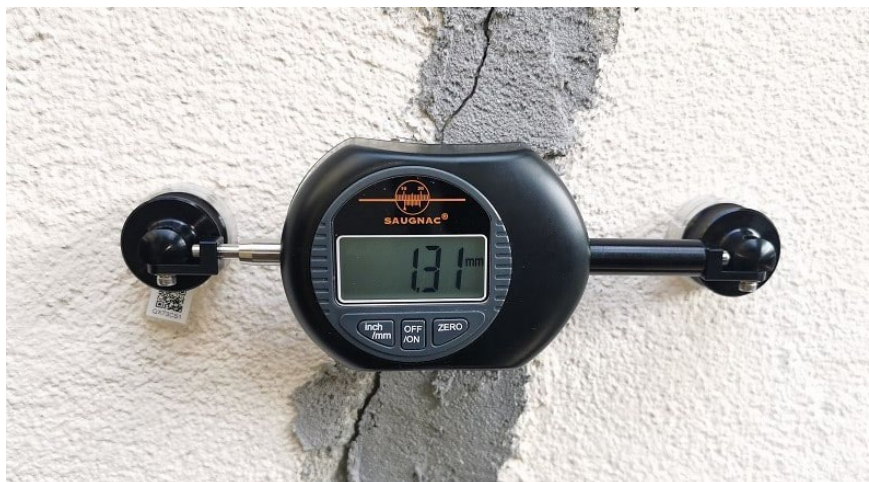
Рис. 3.12. Цифровий маяк марки E1 компанії Saugnac / Digital monitor E1 from Saugnac brand
