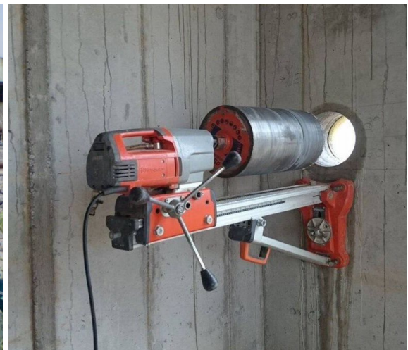
Рис. 6.7. Вирізання керну з бетону для випробування / Cutting a core from concrete for testing
