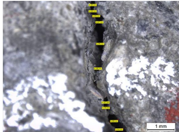
Рис. 3.10. Вимірювання ширини тріщини під оптичним мікроскопом / Measurement of crack width under the optical microscope
