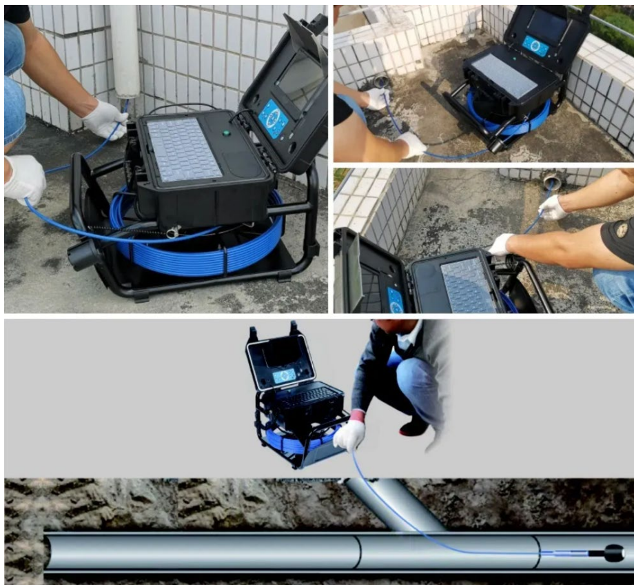
Рис. 6.6. Огляд за допомогою гнучкого бороскопу / Examination using a flexible borescope
