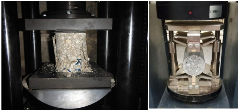
Рис. 6.8. Випробування кернів бетону / Testing concrete cores
