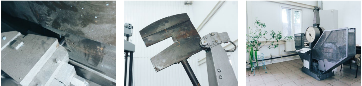
Рис. 6.10. Випробування на ударний вигин (виконує динамічні випробування) які широко застосовуються також для виявлення схильності металів до крихкого руйнування / Impact bending test (performs dynamic tests) which are also widely used to detect the susceptibility of metals to brittle fracture
