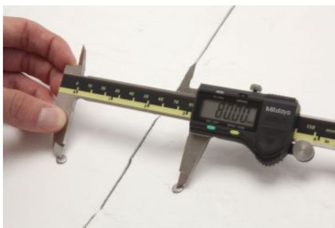
Рис. 3.8. Цифровий штангенциркуль для вимірювання ширини тріщин бетону/залізобетону / Digital caliper for measuring the width of cracks in concrete/reinforced concrete
