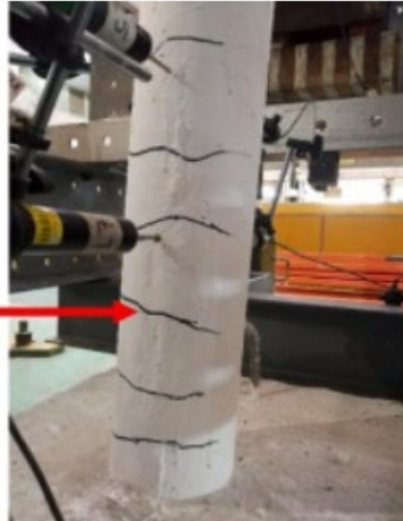
а / а – На колоні з'явилися горизонтальні тріщини / Horizontal cracks appeared on column
