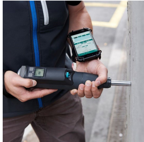
Рис. 6.3. Дослідження міцності бетону методом відскоку, прилад готовий до випробування (а), корпус притиснутий до об'єкта випробування (б), молоток відпущено (с), молоток відскакує (д) / Research of concrete strength by rebound method, the device is ready for testing (a), the body is pressed against the test object (b), the hammer is released (c), the hammer rebounds (d)
