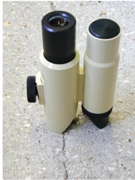
Рис. 3.9. Мікроскоп для вимірювання ширини розкриття тріщин бетону / Microscope for measuring the width of concrete crack opening
