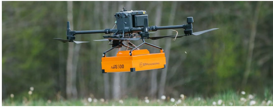
Рис. 3.15. Фото суміщеної роботи георадара із безпілотними системами / Photo of combined operation of GPR with drones
