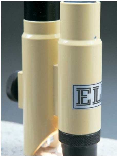
Рис. 3.9. Мікроскоп для вимірювання ширини розкриття тріщин бетону / Microscope for measuring the width of concrete crack opening
