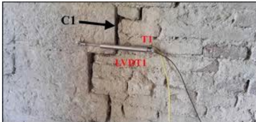
Рис. 3.13. Схематичне зображення (а) та принцип улаштування LVDT (б) для моніторингу розвитку тріщин / Schematic representation (a) and principle of LVDT arrangement (b) for monitoring crack development
