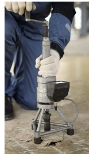
Рис. 6.2. Схема для випробування методом відриву зі сколюванням, загальний вид пристрою під час дослідження (б):
